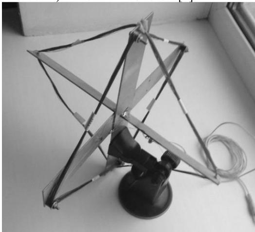
Рис.1. Фото экспериментальной рамочной антенны
