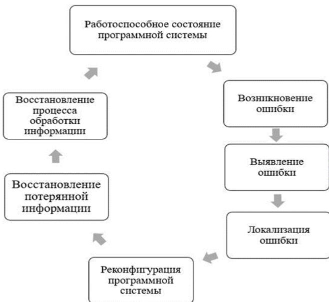
Рис. 1. Процесс проверки программной системы на надежность
