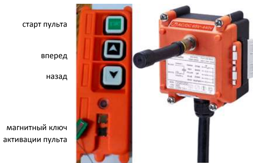
Рис. 2. Внешний вид передатчика (пульта) и приемника дистанционного радиуправления
