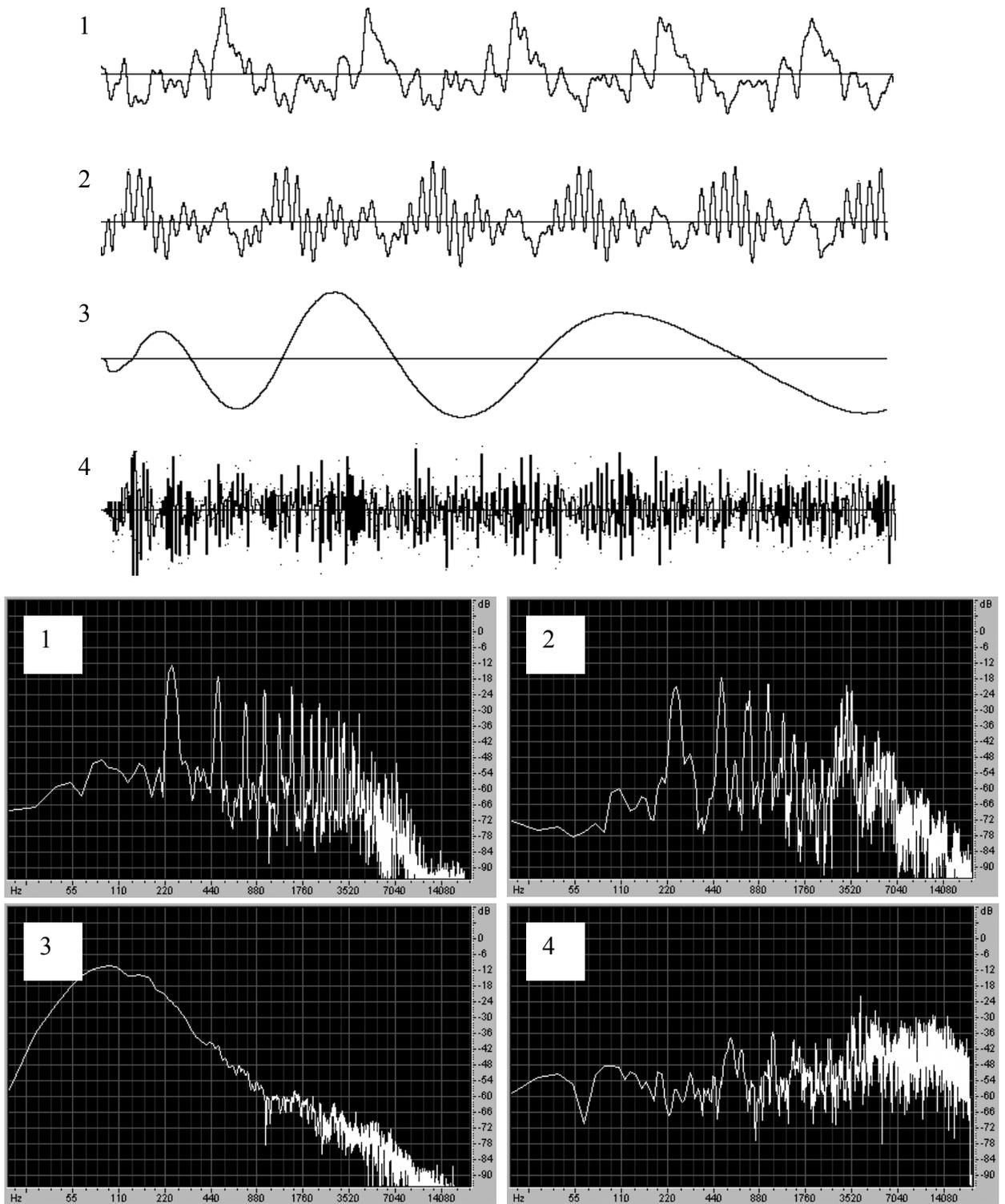
**Рис. 8.** Фрагменты различных сигналов (около 800 точек) и спектры более длинных отрезков этих сигналов (4096 точек). Сверху вниз: нота на фортепиано, голос (пение), барабан (бочка), тарелка (открытый хэт).
