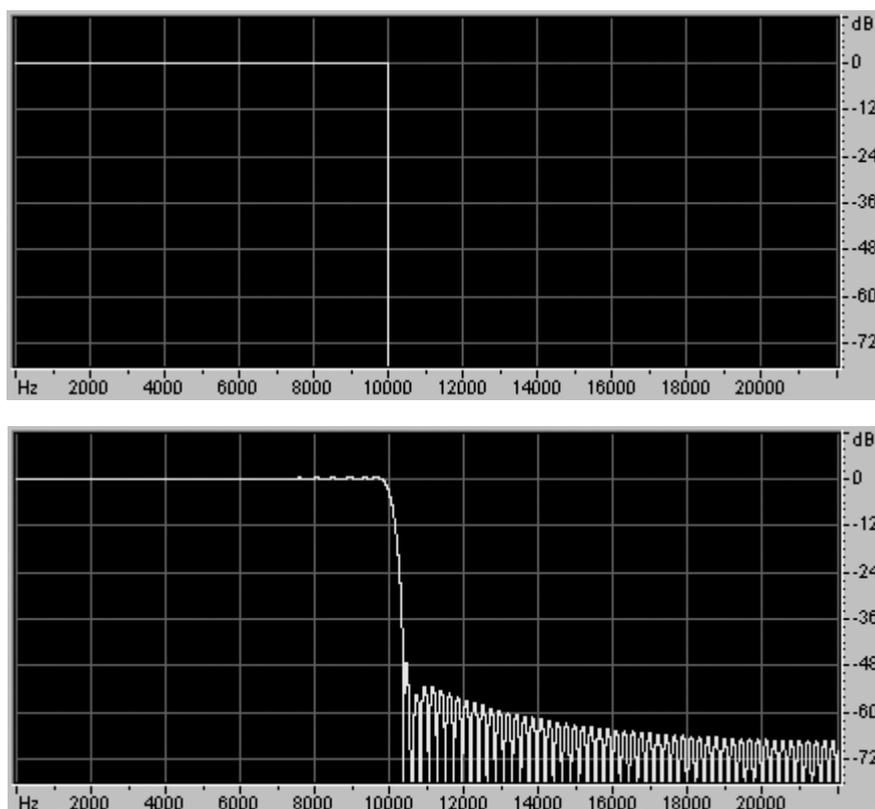
**Рис. 10.** Частотные характеристики идеального (сверху) и одного из реальных НЧ-фильтров.
