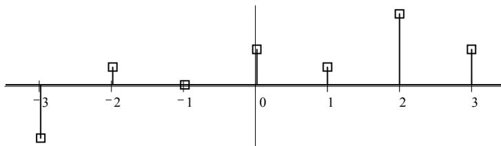
**Рис. 1.** Так мы будем изображать дискретные сигналы: по оси абсцисс отложены дискретные моменты времени, по оси ординат – амплитуды сигнала в эти моменты. Отметим, что соединить дискретные отсчеты сигнала на графике прямыми линиями было бы не совсем верно, т.к. при восстановлении непрерывного сигнала по дискретному используются более сложные интерполирующие функции.
