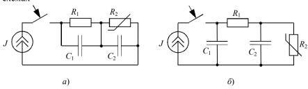
*Рис.1. Схемы:*  $a - \Phi$ остера; 6 - Kауэра.
