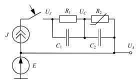
Рис.2. Теплоэлектрическая модель LM2676
