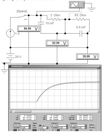
Puc.4. Теплоэлектрическая модель ВИПН LM2676 в программе Electronics Workbench (EWB512)
